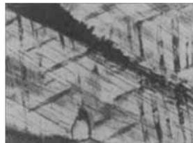
Abbild. 6.  $\gamma$ -Hexachlor-cyclohexan. Monokline Form III durch Umwandlung aus Modifikation I
